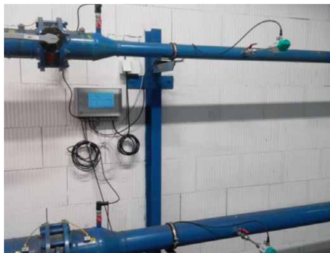
Obr. 4 Ultrazvukové měření průtoku kapalin pro určení chladicího výkonu.
